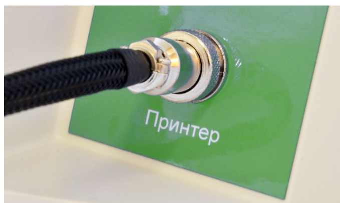
Рисунок 19 – Подключение соединительного кабеля принтера к КИК
