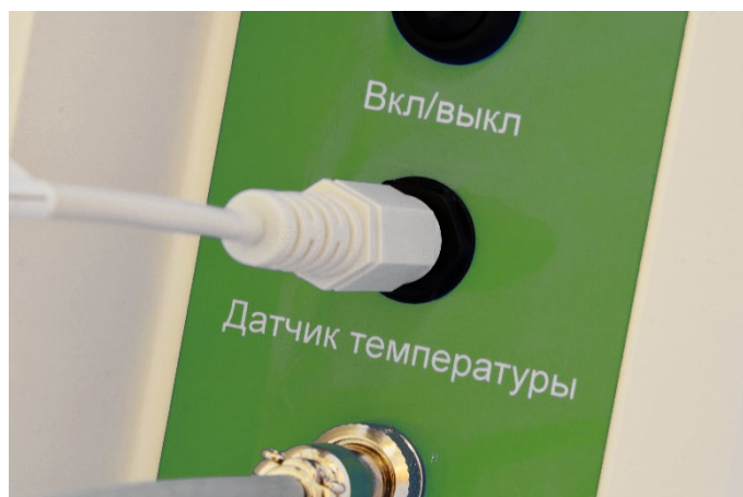
Рисунок 15 – Подключение датчика температуры к КИК
